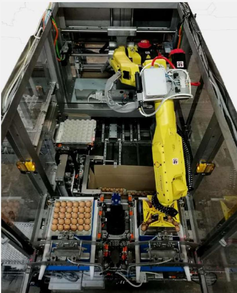
Celda robotizada con formadora de cajas integrada, creada especialmente para la colocación de bandejas y estuches en cajas cerradas
