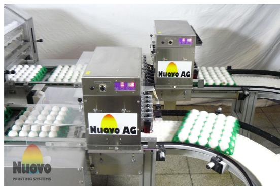
*Capacidad según la capacidad de la clasificadora o empacadora de granja (hasta 54.000 huevos/h en una empacadora de granja)*
